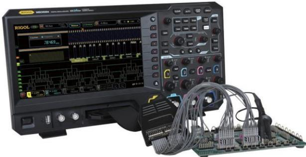
現在の設計分野では、高度に統合されたデジタル・オシロスコープが設計エンジニアにとって有益なツールとなっています。リゴルのMSO5000 シリーズ・デジタル・オシロスコープは、デジタル・オシロスコープ、16チャンネル・ロジック・アナライザ、FFTアナライザ、任意波形発生器、デジタル電圧計、周波数カウンタと積算器、プロトコル・アナライザの7種の測定機能を1つの測定機に統合しました。MSO5000シリーズは実ニーズに対応するフレキシブルで経済的なソリューションを提供します。
