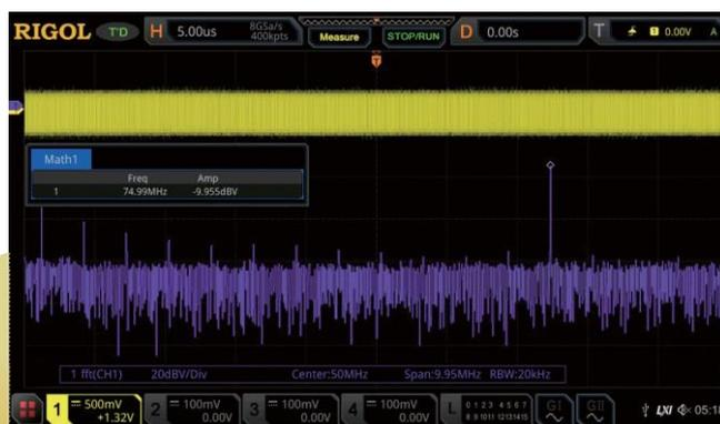
近接界プローブを使用すれば、プローブを放射ノイズの漏洩ポイントに近づけて、周波数ピークを容易に観測することができます。
