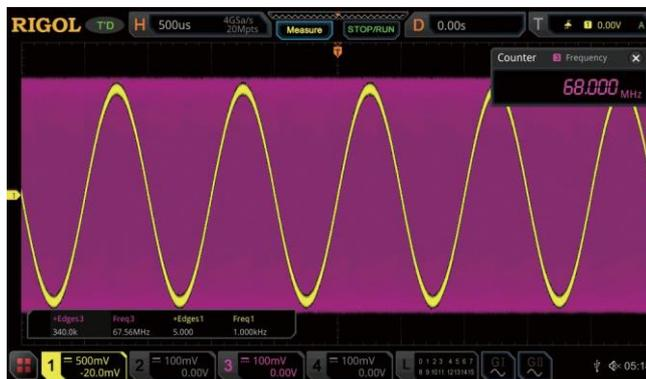
周波数の差が大きい2つの信号を観測し、正確に測定します。フル・メモリ・ハードウェア測定は340k個もの立ち上がりエッジのある信号の正確な周波数を測定可能です。
