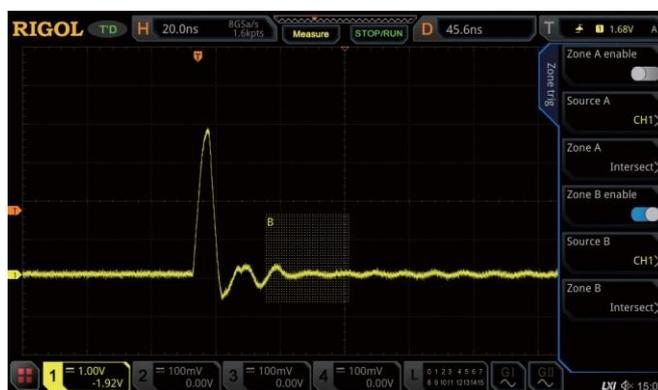
エッジトリガとゾーンAの組み合わせで容易に過渡的な信号でトリガをかけることができます。
